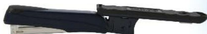
Положение степлера для прямого типа шивания, при котором ножки скобы не загибаются
